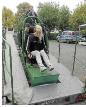
Martha Betermann und Niklas Bonner erleben im Gurtschlitten, die Wirkung eines Aufpralls bei 7 bis 10 Stundenkilometern.
